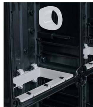
Modulární připojovací systém VARIABOX umožňuje díky vnitřním průchodům (horizontální průchodka M50 a vertikální obdélníkový otvor 160x70mm) snadné propojení jednotlivých modulů i při velkých průřezech vodičů.
