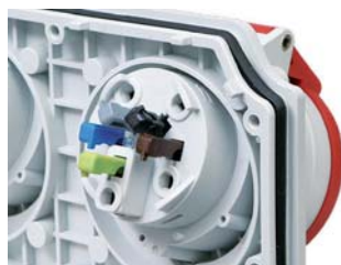
Radiální těsnění zajišťuje dokonalou těsnost montovaných dílů. Všechny zásuvky CEE jsou vybaveny bezšroubovým systémem připojení QUICK CONNECT. Díky barevnému označení pólů je údržba snadnější.
